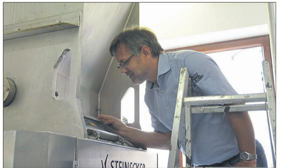
Das Malz wird geschrotet und mit Wasser gemischt. Hans Senff wirft einen Blick in den Maischkessel.
